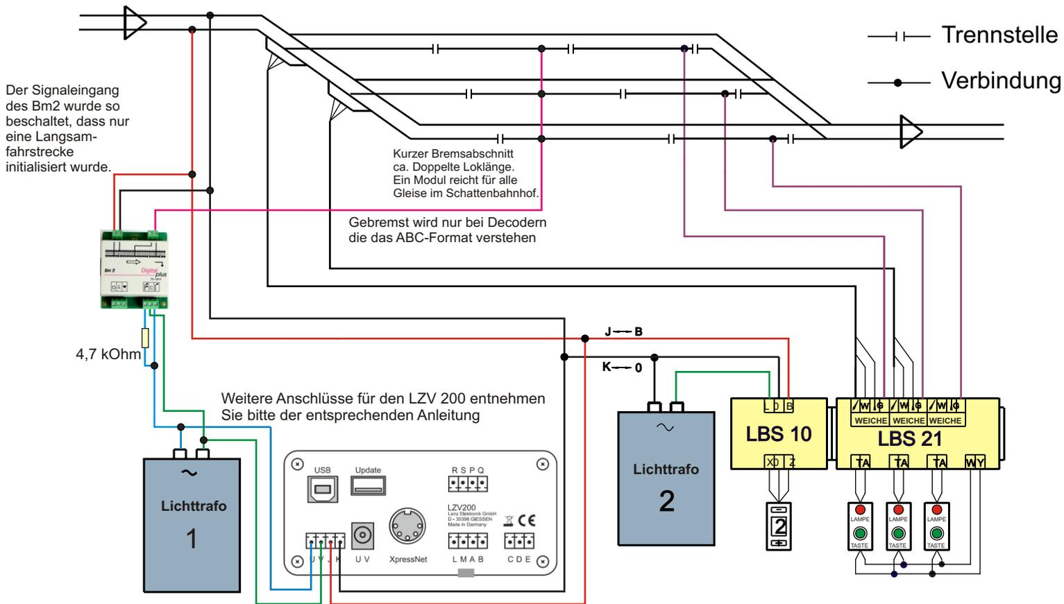
Durch übersichtlich angeordnete Anschlussklemmen, ist der Aufbau ein Kinderspiel. Das Bild zeigt die Verdrahtung für den konventionellen Betrieb.
